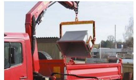
Vaciado de la arena a la plataforma de un camión (se muestra con 700 L el contenedor de arena)
