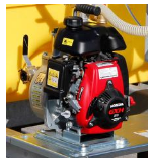
Bomba Honda con motor de gasolina 130 L/min
