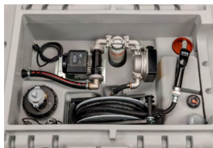
Indoor Premium Contador K33, filtro con separador de agua, carrete de manguera con manguera de 8 m DN 19, sin cubierta abatible
