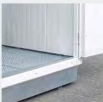
Die in allen Ausführungen integrierte, verzinkte und flüssigkeitsdicht verschweißte Auffangwanne fängt mögliche austretende Flüssigkeiten optimal auf. Die darüber liegenden Gitterroste sind bis 1.000 kg/m<sup>2</sup> belastbar.
