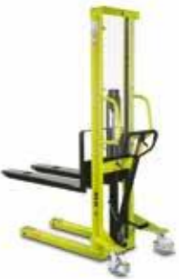
MX Elevación máxima (m): 1.6 Capacidad (t): 0.5 - 1.0
