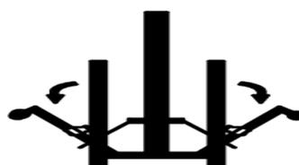
Ubicar las horquillas en su alojamiento y colocar el perno de sujeción.
