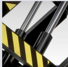
La fuerza de elevación se produce por la actuación de **uno o dos cilindros hidráulicos** fijados en el interior del mecanismo de tijera.
