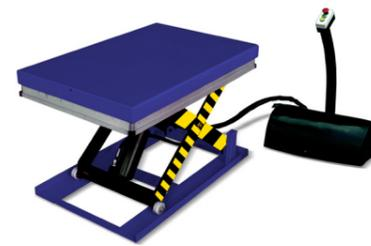
Sistema de elevación por mecanismo de simple tijera con rodamientos libres de mantenimiento. Su tamaño reducido proporciona la mejor solución para uso eficaz y cómodo en el taller.
