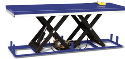
Sistema de elevación por mecanismo de dos tijeras simples con rodamientos libres de mantenimiento. La fuerza de elevación se produce por la actuación de uno o dos cilindros hidráulicos fijados en el interior del mecanismo de tijera.
