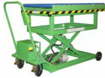
Mesa elevadora móvil con rodillos
