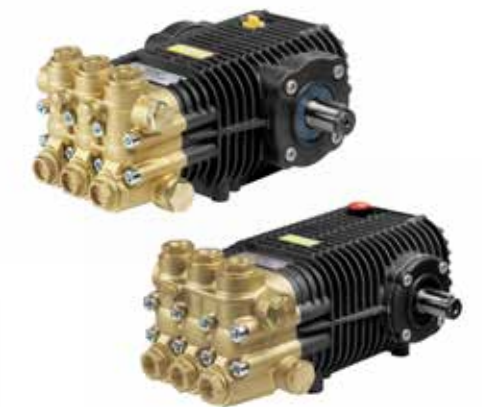
Bombas TWN y RW Premium con 3 pistones cerámicos integrales y cabeza de bomba de latón. Dos indicadores de aceite.
