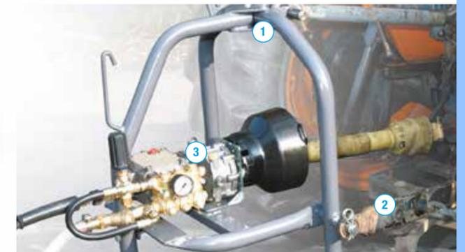
1. Acoplamiento para el tercer punto de articulación del tractor, diám. 19 - 25 mm.
