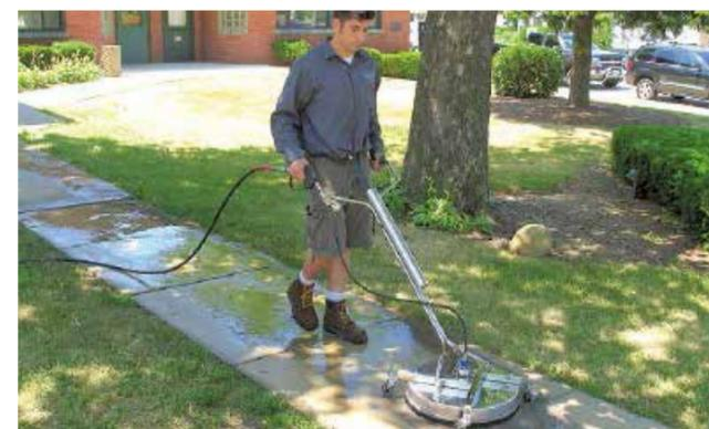
Brazo rotor, puede soportar hasta 275 bar.
