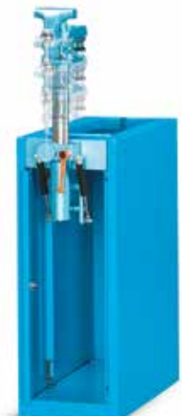
4 Se regula el tornillo hidráulico a la altura deseada.
