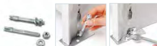
Kit de fijación al suelo formado por 2 tornillos de acero M8x75 mm para suelo de hormigón igual o superior a la clase B25/RBK250/MPA 25N /mm<sup>2</sup>
